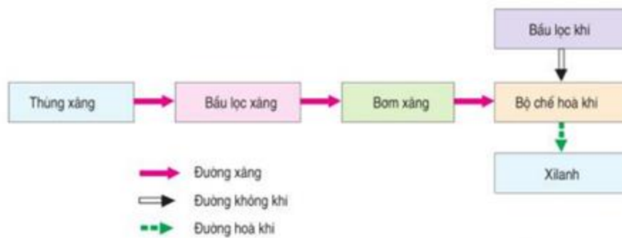
Hình 27.1. Sơ đồ khối hệ thống nhiên liệu dùng bộ chế hoà khí
